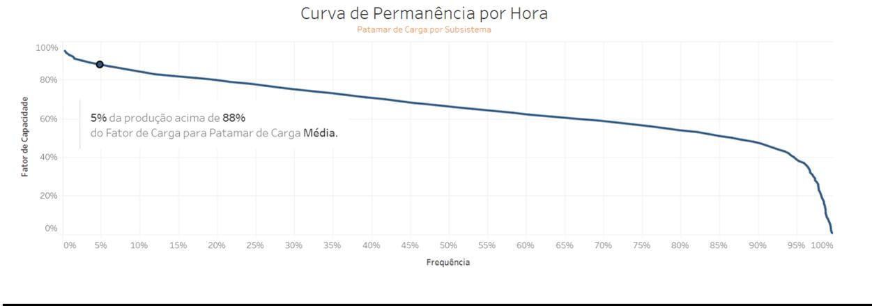
**Figura 9 – Curva de Permanência da Geração Solar para Área Minas considerando um Risco de 5% (Carga Leve)**
