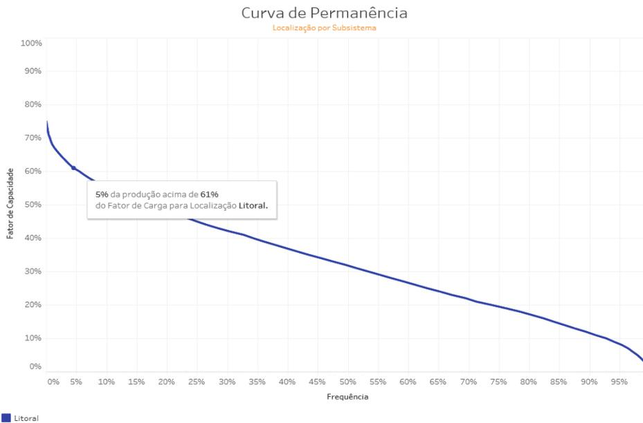
**Figura 3 – Curva de Permanência da Geração Eólica para o Subsistema Norte/Nordeste considerando um Risco de 5% (Carga Média – Interior)**
