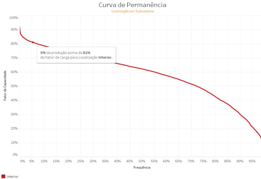
**Figura 2 – Curva de Permanência da Geração Eólica para o Subsistema Norte/Nordeste considerando um Risco de 5% (Carga Leve – Litoral)**
