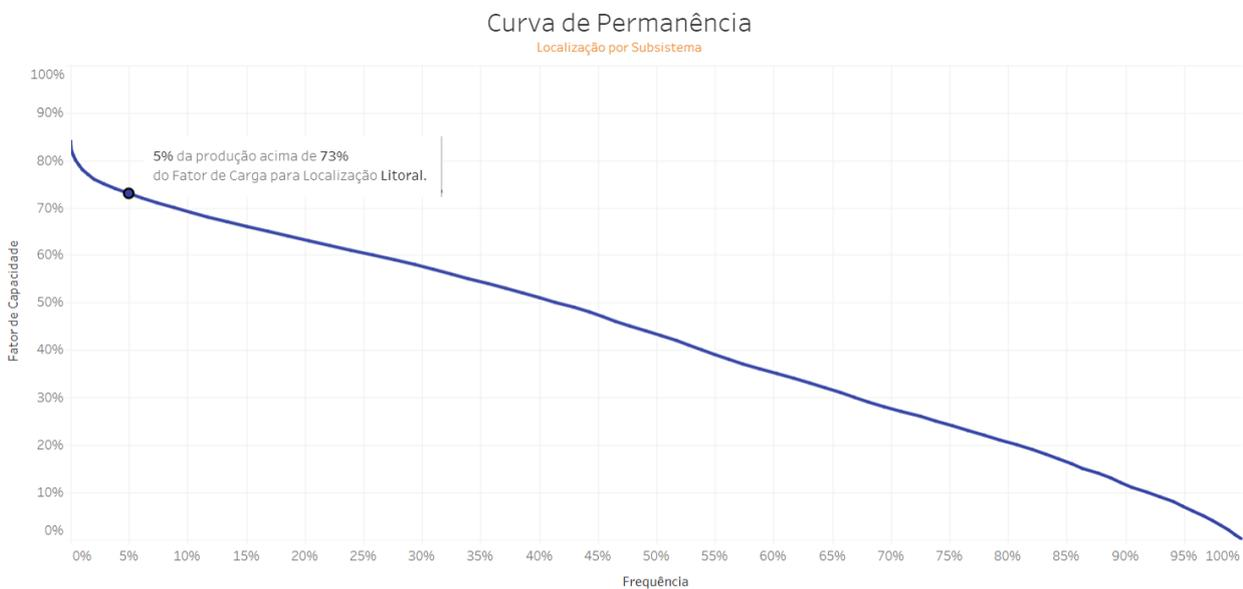
**Figura 5 – Curva de Permanência da Geração Eólica para o Subsistema Sul considerando um Risco de 5% (Patamar de Carga Média)**
