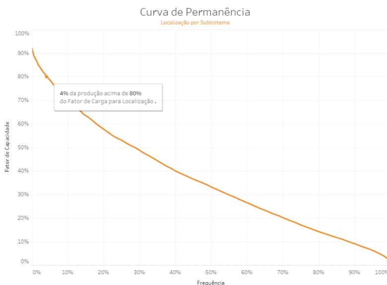
**Figura 7 – Curva de Permanência da Geração Solar para o Subsistema Norte/Nordeste considerando um Risco de 5% (Carga Leve)**
